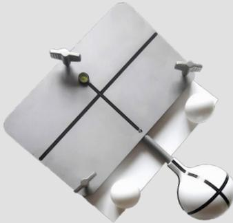
Mesurer la position et la taille des isocentres de rayonnement LINAC (MV KV CBCT) et les angles de rotation du rayonnement (bras colli table) améliorés avec l'option SGRT.
